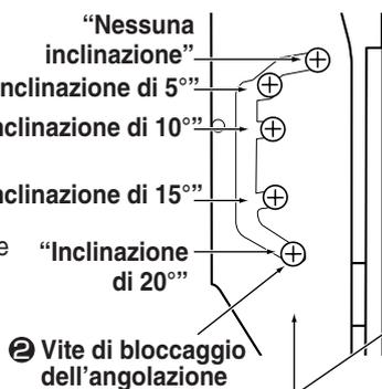
② Vite di bloccaggio dell'angolazione
