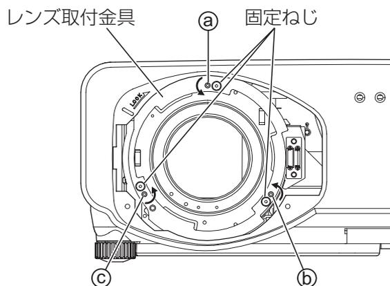
（調整ねじ ①、②、③はレンズ装着状態で調整します）
