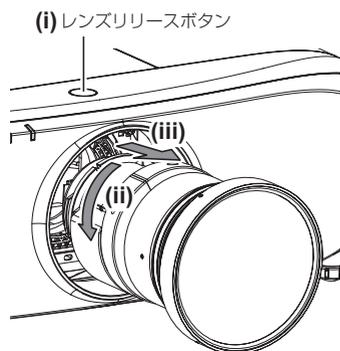
レンズリリースボタンを押しながら反時計方向に投写レンズを回しきり、投写レンズを取り外す
