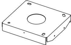
1個                                                                                                                                                | 本金具を天井に、4本のつりボルトを介して取り付けます。取り付け方法には、コンクリートと木造天井の場合の2通りがあります。 |
