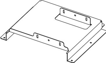
1個                                                                                                                                                | 本金具にプロジェクター本体を取り付けます。左右傾きの調整機能があります。                         |
