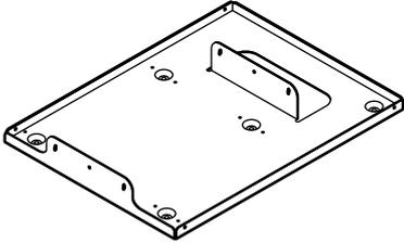
1個                                                                                                                                        | 本金具にプロジェクター本体を取り付けます。<br>調整機能…左右傾きの調整ができます。                        |
