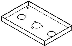
1個                                                                                                                                        | 本金具を天井につりボルトを介して取り付けます。取り付け方法には、コンクリートと木造天井の場合の2通りがあります。           |
