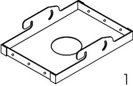
1個                                                                                                                                      | プロジェクター取り付け金具に取り付けます。<br>調整機能…上下方向の調整ができます。                        |
