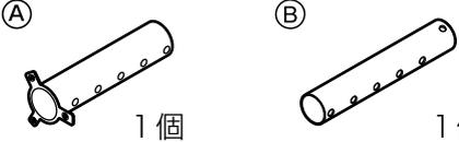
1個 1個                                                                                                                                   | アタッチプレートとプロジェクター取り付け金具の中継ポールです。<br>調整機能…天井からプロジェクター本体への高さの調節ができます。 |
