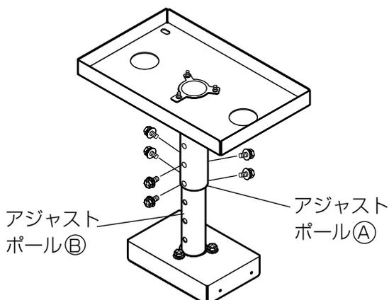
アジャストポール④にアジャストポール⑥を差し込み、穴の位置を合わせ、付属の六角ボルト(M6×12)6本で固定する。
