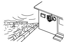
屋外設置時は、本製品近くに屋外用の電源ボックスを設置して付属のACアダプターをその中に入れて、使用してください。
