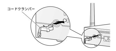
2 ACアダプターのDCプラグをDC INジャックに差し込み、ACアダプターを 電源コンセントに差し込む
