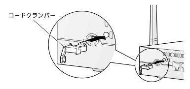
2 ACアダプターのDCプラグをDC INジャックに差し込み、ACアダプターを 電源コンセントに差し込む
