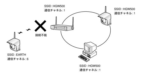
本機に接続する無線端末は、本機と同じSSIDが設定されていれば、通信チャネルが自動的に設定され通信可能となります。
