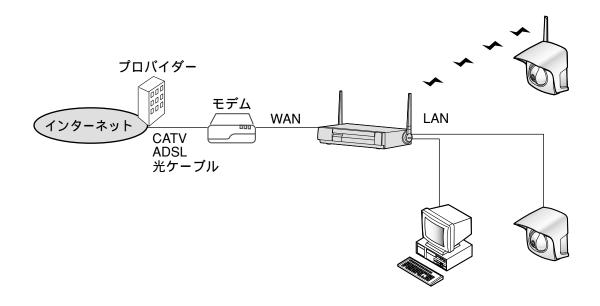
接続タイプ2(社内ネットワークに接続する場合 🖙 42ページ) WAN側を社内ネットワークに接続し、LAN側にネットワークを構築します。
