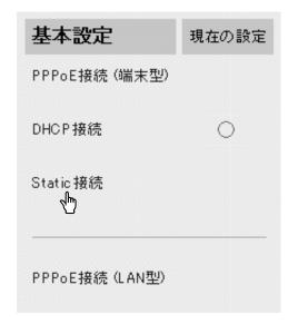
「IPアドレス」「サブネットマスク」 「ゲートウェイ」「DNSサーバー1」 「DNSサーバー2」を入力し、プロバイダーから指定がある場合は、「ドメイン名」を入力する
