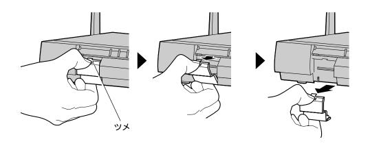
ク SDメモリーカードスロットにSDメモリーカードを差し込み、カバーを閉める
