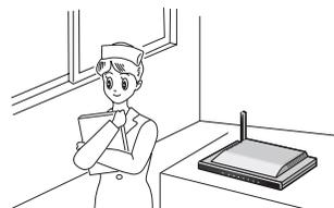
自動ドア、火災報知器などの自動制御機器の近くには設置しない
