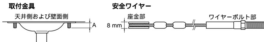
アンカーボルトの長さ（A）＝座金部の厚さ＋ダブルナットの厚さ＋（mm）を満たす寸法
