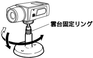
6. ビデオ受像機の画面を見ながら雲台固定リングを少しゆるめ、カメラの角度を調節します。
