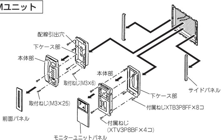
② パネルユニットにカラーモニター室内親機本体下ケースを付属ネジ3×10 mm (4ヶ所) でネジ止めする。
