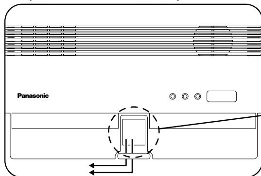
Ⓐ,Ⓑ,Ⓒ(斜線部)のつなぎ目(8ヶ所)をニッパー等で切断してケーブルを入線してください。
