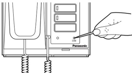
表示パネルの上から試験スイッチをつまようじなどの細い棒で押す。
