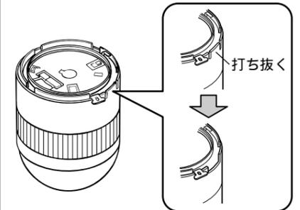
**5** 本金具の上ケースと下ケースを外します。下ケースの目印（5ヶ所）を押しながら下げると外れます。
