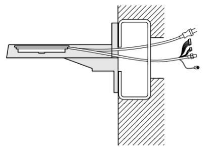
**9** カメラ本体に固定されている安全ワイヤーをベースユニットに取り付けます。安全ワイヤーの先端リングが確実にベースユニットのフックにかかっていることを確認してください。
