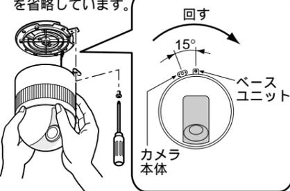
**11** 下ケースを取り付けます。パチンと音がするまで確実に押し込んでください。
