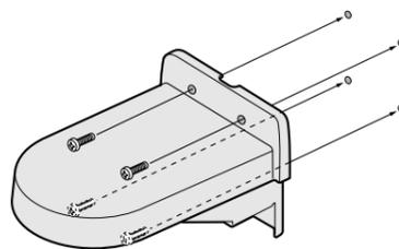
**8** ケーブル類を配線します。壁の裏など、取付場所に合わせてケーブル類を配線します。
