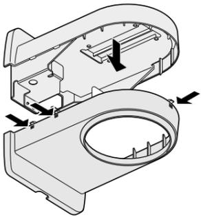
**6** 上ケースにカメラのベースユニットを取り付けます。付属のねじ（M4-L8）を使用し、ベースユニットを下図の向きで取り付けてください。
