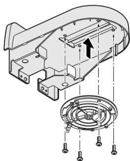
**7** 上ケースを壁に取り付けます。ねじで4ヶ所を固定します。ねじは付属していません。取付場所に合わせて用意してください。
