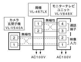
通話端子、映像入力端子の待受時電圧および動作時電圧
