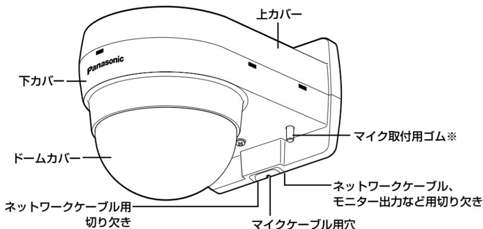
※マイクを使用するときは、マイク取付用ゴムにマイクを取り付けてください。使用しないときは、マイク取付用ゴムをニッパーで切るなどの処理をしてください。
