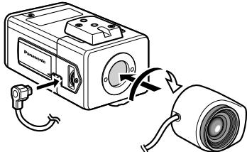
1. レンズをゆっくり時計方向に回して取り付け、レンズケーブルをカメラのALCコネクターに接続します（☞36ページ参照）。
