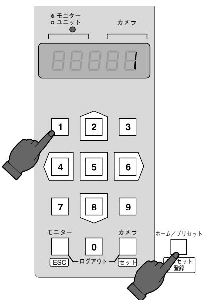
**1** システム機器、モニター選択後、コンビネーションカメラを選択する。
