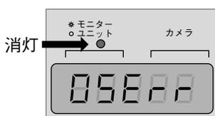
入力したユニットアドレスの機器がシステムに接続されていない場合の表示例
