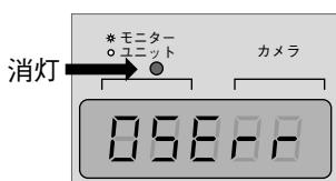
入力したユニットアドレスの機器がシステムに接続されてない場合の表示例
