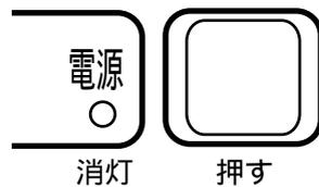
電源を切ります。電源スイッチは2秒以上押ししてください。電源が切れると電源表示ランプが消灯します。
