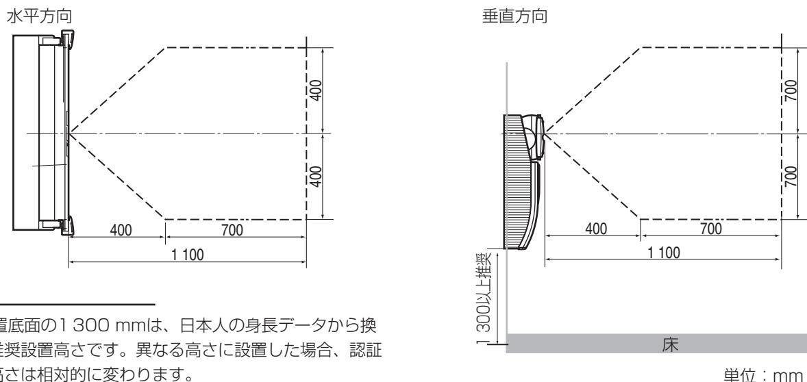
注：設置底面の1300 mmは、日本人の身長データから換算した推奨設置高さです。異なる高さに設置した場合、認証できる高さは相対的に変わります。
