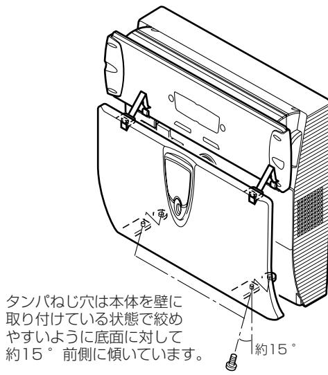
タンパねじ穴は本体を取り付けている状態で絞めやすいように底面に対して約15°前側に傾いています。
