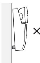
注：壁取付金具の本体取付フックに本体取付フック受けが4か所とも確実に入っていることを側面から見て確認してください。
