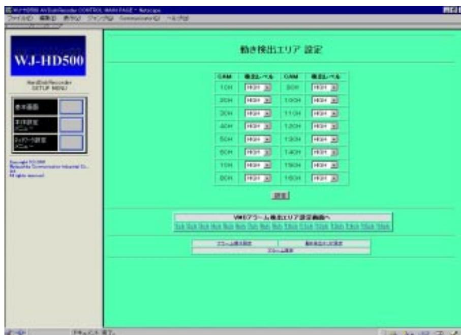
2. カメラ1～16（CAM 1CH～16CH）の検出レベルを設定します。
