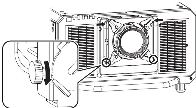
5) レンズ固定アタッチメント金具の上部を、「レンズ固定アタッチメントの準備」の手順 1) で外したつまみねじを使って固定します。
