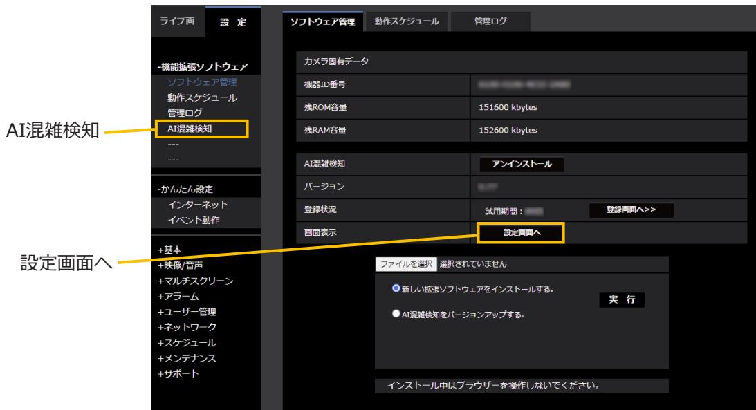
「AI混雑検知」メニューをクリック、または【設定画面へ】をクリックすると、「混雑検知機能設定」画面が開きます。なお、「混雑検知機能設定」画面を開くためには、「機能拡張ソフトウェア」ページ > 「動作スケジュール」タブでスケジュール登録を行なう必要があります。
