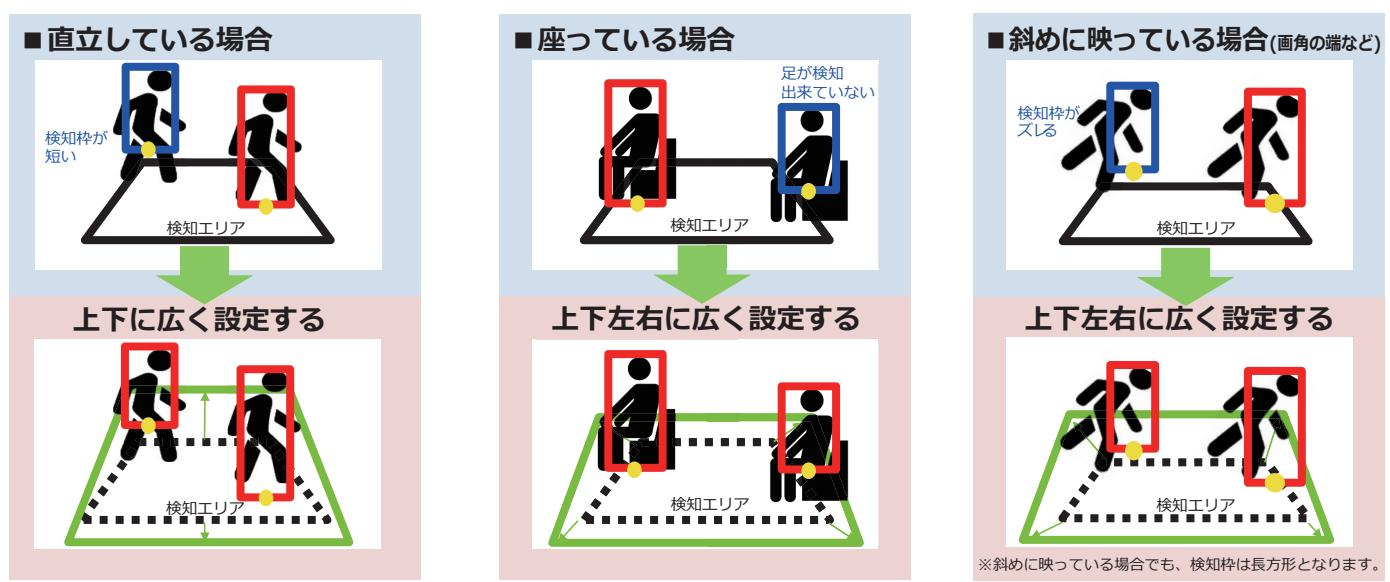
※検知エリア内判定されている検知枠は「赤」、検知エリア外判定されている検知枠は「青」で示しています。
