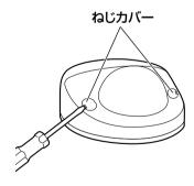
エンクロージャーを取り外します。エンクロージャーの両側を押さえてフックを外してから取り外します。
