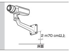
3-2 落下防止ワイヤーの取付フックを、建築物の基礎部分または十分な強度があ る部分に固定されたワイヤー取付プレート(落下防止ワイヤーキットに付属) またはワイヤー取付金具(落下防止ワイヤーキットに付属)に引っ掛けます。
