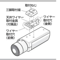
●取り付けは、必ず外したねじを使用してください。長さの違うねじを使用する と、落下や故障の原因となります。
