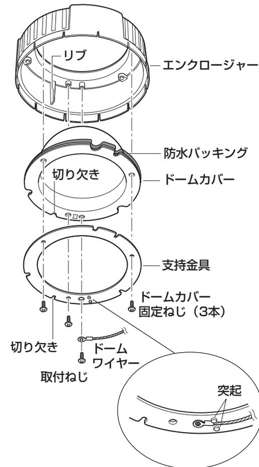
4. 対応する六角レンチなどを使って、カメラ本体とエンクロージャーをエンクロージャー固定ねじ3本で取り付けます。
