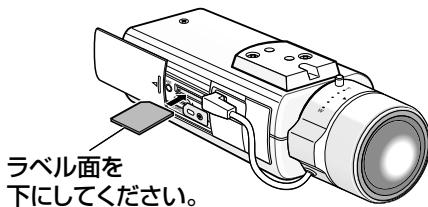
**2** 必要に応じてSDメモリーカード留め金具のねじをゆるめ、右に90°回転させてねじを締め付けます。
