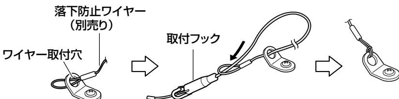
①落下防止ワイヤーの輪の部分をワイヤー取付穴に通します。
