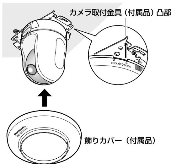
②飾りカバーの左右「LOCK」にカメラ取付金具の凸部がくるまで、飾りカバーを時計回りに回してはめ込みます。
