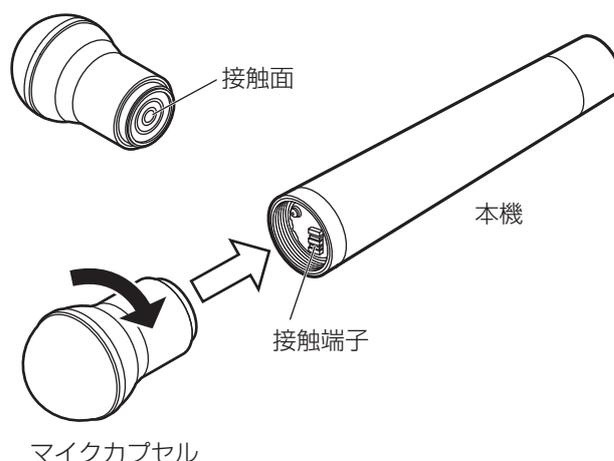
※お買い上げ時には、保護カバーが付いていますので保護カバーをはがしてからマイクカプセルを取り付けてください。
