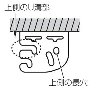
**重要** ● M8ボルトが固定金具のU溝部に確実にハマり込むまでは、スピーカー本体から手を離さないでください。
