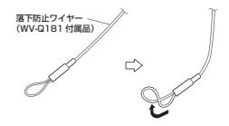
**2** 落下防止ワイヤー(WV-Q181付属品)をワイヤー取付穴に取り付けます。
