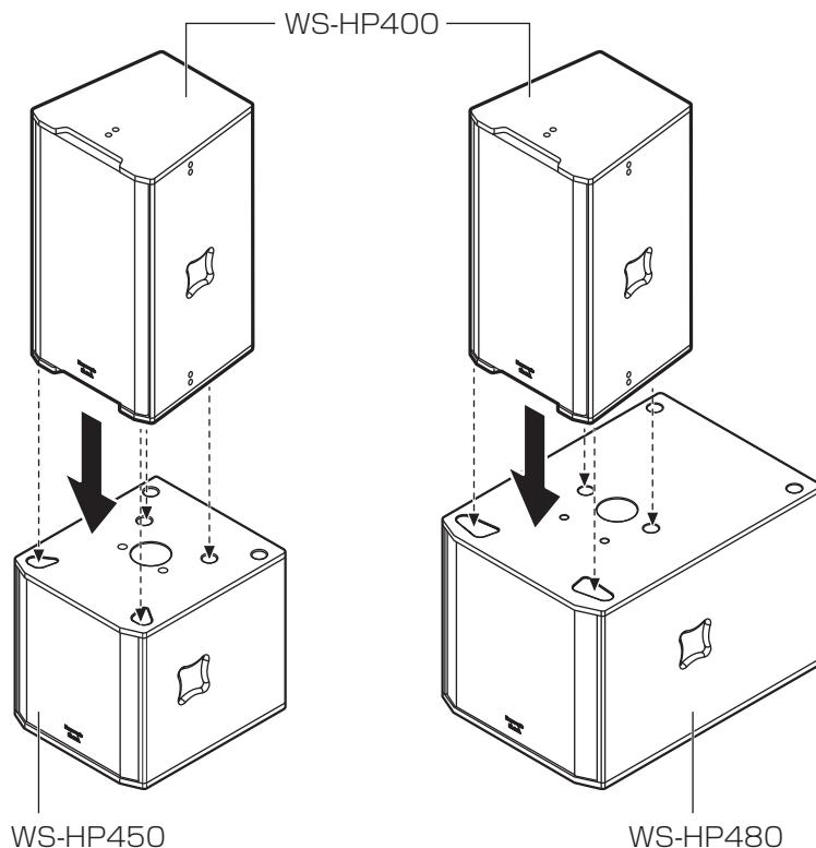
WS-HP400のゴム足とWS-HP450、WS-HP480凹部の位置を合わせる
