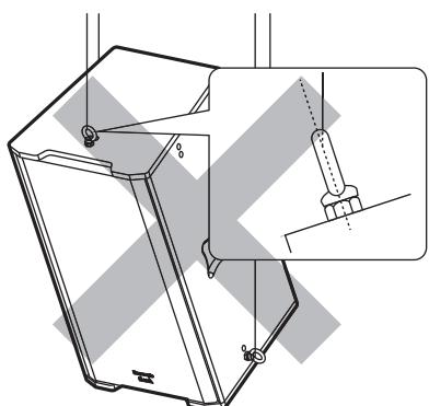
アイボルトとワイヤーの取り付け角度が誤った状態での設置
