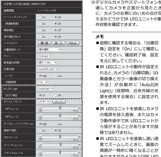
④デジタルカメラやスマートフォンを通してカメラを正面から見たときに、カメラの左側に白い光の点が見えるかどうかでIR LEDユニットの動作状態を確認できます。
