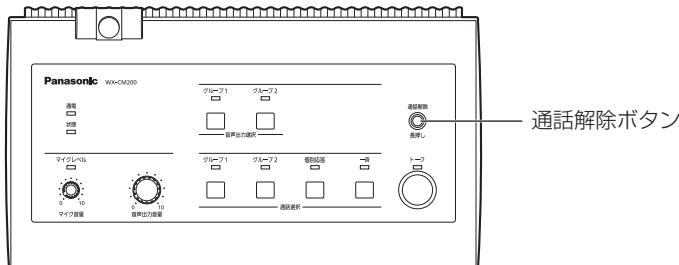
外部スピーカーから「ピピッ」音が聞こえたら、すべてのポータブルトランシーバーの通話状態が解除されます。
