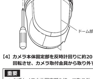
●必ずカメラ本体固定部を持って取り外してください。ドーム部を持ちながら取り外すと、故障の原因になります。
