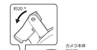
[4] カメラ本体固定部を反時計回りに約20°回転させ、カメラ取付金具から取り外す。
