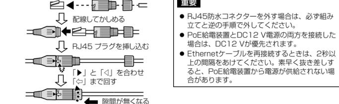
**■外部I/Oケーブル、電源接続ケーブル、オーディオ入力ケーブル、オーディオ出力ケーブルの防水処理**
