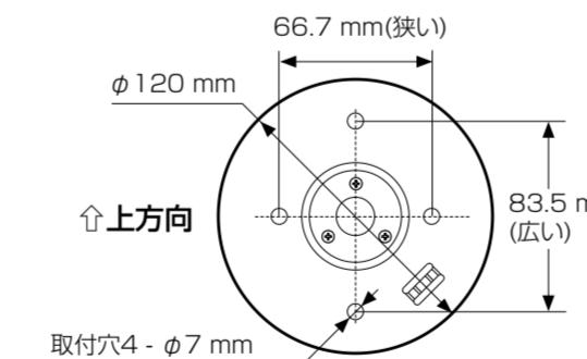
[2] カメラ取付台(WV-Q181) を設置面に取り付ける。
