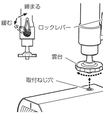
[2] カメラの取付ねじ穴にねじ山を合わせ、雲台を矢印の方向に回してカメラ本体を取り付け固定する。
