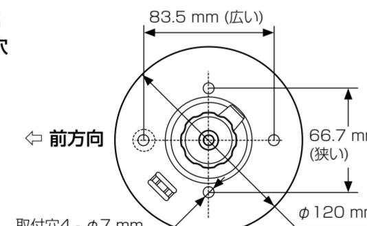
[2] カメラ取付台(WV-Q180) を設置面に取り付ける。
