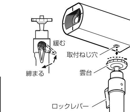
[2] カメラの取付ねじ穴にねじ山を合わせ、雲台を矢印の方向に回してカメラ本体を取り付け固定する。
