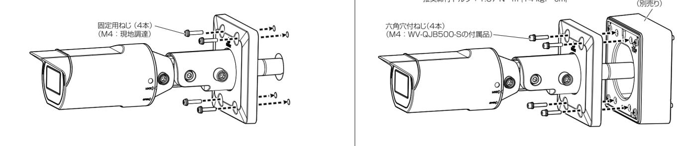
**QJB500** 対辺3 mmの六角レンチ(現地調達)を使って六角穴付ねじ(4本)(M4:WV-QJB500-Sの付属品)で固定する。
