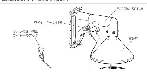
WV-QCL501-Wに落下防止ワイヤーを取 り付ける場合は、以下の手順で取り付け作 業を進めてください。
