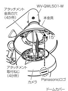
②ビット(カメラ付属品)を使ってドームカバー固 定ねじ(4本)を緩め、ドームカバーをカメラよ り取り外します。
