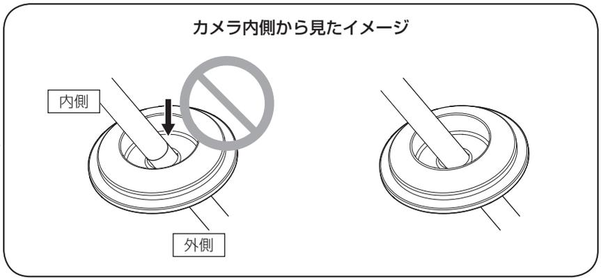
**Step 2** ● 既設カメラの防水コネクタ部分が破損している場合は、再度ネットワークケーブルを加工し、付属の防水コネクタを取り付けてください。（⇒既設のカメラ取扱説明書 設置編参照）
