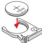
古い電池を取り出し、新しいリチウムコイン電池 (CR2025) を「+」表示が図の上側になるように入れる。
