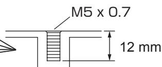
ねじの締め付けトルク：1.2 ± 0.1 N·m
