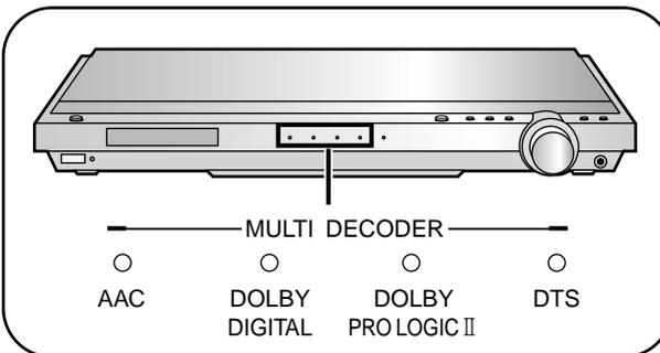
入力ソースにより次の MULTI DECODER ランプが点灯します。
