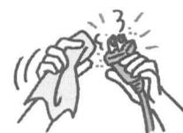
湿気などで絶縁不良になり火災・感電の原因となります。電源プラグを抜き、乾いた布でふいてください。
