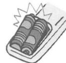
機器の表示通り正しく入れてください。間違えますと電池の破裂、液もれにより、火災・けがや周囲を汚損する原因となることがあります。
