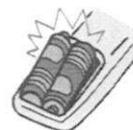
機器の表示通り正しく入れてください。間違えますと電池の破裂、液もれにより、火災・けがや周囲を汚損する原因となることがあります。
