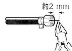
出ている芯線が約2mmになるようにニッパで切断する
