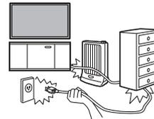
傷つけたり、加工したり、重いものをのせたり、加熱したり、熱器具に近づけたり、無理に曲げたり、ねじったり、引っぱったりすると芯線の露出、ショート、断線により火災・感電の原因となります。
