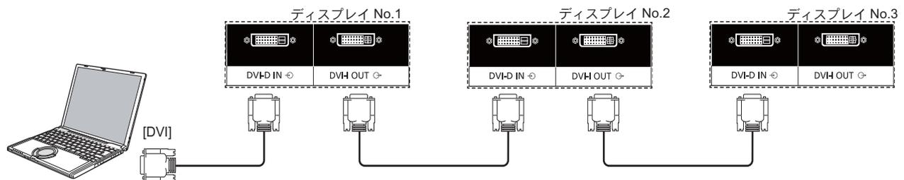
L 型のコネクタを使用する場合も含めて、確実に接続するため、両端のネジを確実に締めてください。ネジが確実に固定されていない場合、デージーチェーンの接続が不安定になる可能性があります。
