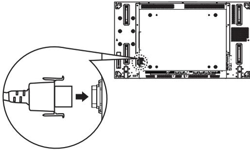
2. カチッと音がしてはまるまで、電源コードをしっかりと差し込みます。電源コードは左右両側がロックされていることを確認してください。
