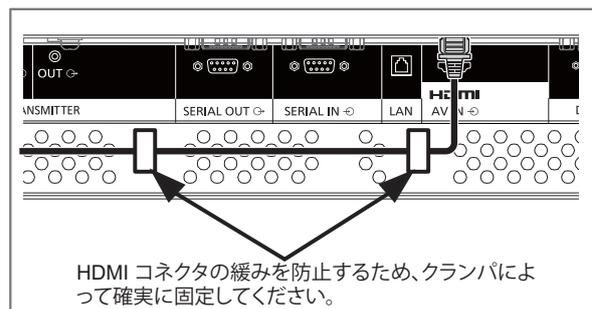
HDMI コネクタの緩みを防止するため、クランプによって確実に固定してください。
