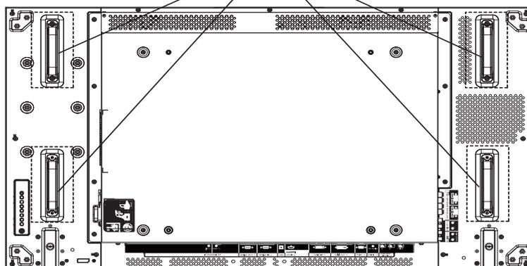
ディスプレイをマルチで設置する場合、電源 OFF の状態で、各ディスプレイの間に 0.5mm の間を設けてください。
