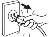
コードを引っばると、コードが破損し、感電・ショート・火災の原因となることがあります。
