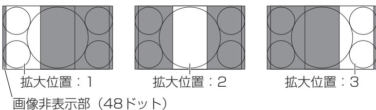
16:9の映像を表示するのに適しています。4:3の映像は横に拡大された画像になります。また、画像の両端が48ドット分カットされます。
