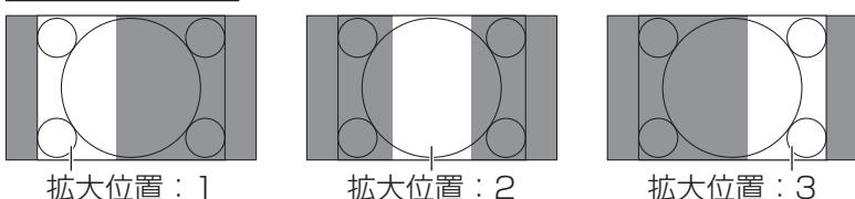
4:3の映像をそのままの比率で表示します。各拡大位置間で画像に重なりが生じますが、画面位置／サイズの調整で表示位置を調整すると重なりを解消できます。（☞ 28ページ）
