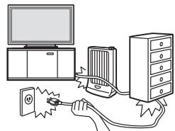
傷つけたり、加工したり、重いものをのせたり、加熱したり、熱器具に近づけたり、無理に曲げたり、ねじったり、引っ張ったりすると芯線の露出、ショート、断線により火災・感電の原因となります。
