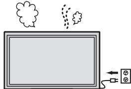
■ 内部に異物や水などの液体が入ったり、本機を落としたり、キャビネットが破損したら、電源プラグを抜く！
