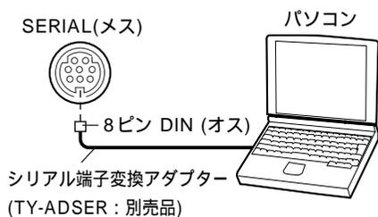
フェライトコア付きRS-232Cシリアル端子変換アダプターET-ADSERを必ず使用してください。
