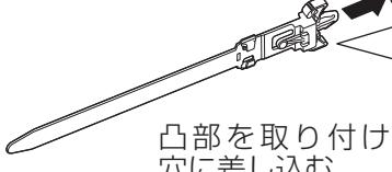
凸部を取り付け穴に差し込む
