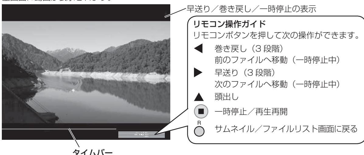
再生中に ◀ を押すと巻き戻し、▶ を押すと早送りを行います。ボタンを押すたびに、早さが 3 段階で変わります。
