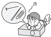
内部に金属類や燃えやすいものなどを差し込んだり、落とし込んだりしないでください。火災・感電の原因となります。
